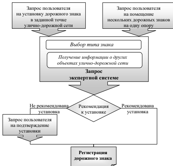
Рис. 4. Схема установки дорожного знака на УДС
