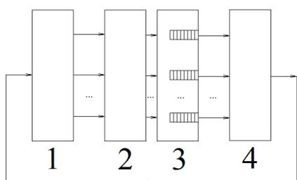
Рис. 1. Наглядное представление построенной модели компьютерной сети передачи данных: 1 – блок распределения пакетов на входе, 2 – блок перераспределения пакетов по выходам, 3 – блок очередей, 4 – блок обработки информации о выходных пакетах
