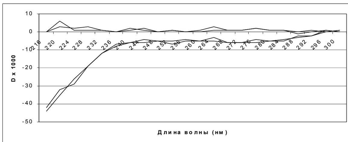
**Рис. 1.** Дифференциальный спектр оптического поглощения двух идентичных кювет с физраствором. Две верхние кривые – повторы контрольной записи дифференциального спектра до воздействия источника векторного потенциала. Две нижние кривые – повторные записи после 20-минутной экспозиции одной из кювет в поле векторного потенциала
